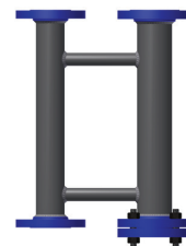
FF2 Flange Top/Flange Bot, Flg/Mating Flg
